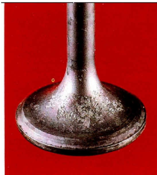
Daños ocasionados por el azufre del combustible.
