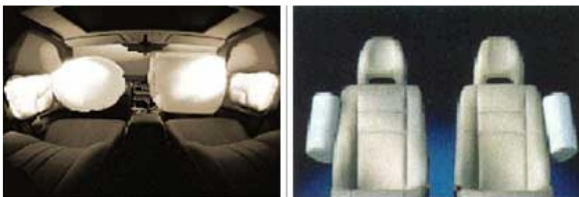
Tipos de montaje de airbags laterales: en las puertas (izquierda) y en los asientos (derecha)
