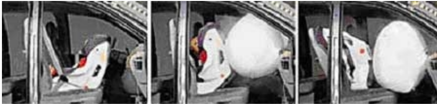
Consecuencias de instalar una silla para niños mirando hacia atrás en el asiento delantero
