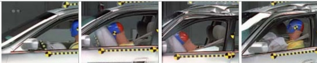
Secuencia de funcionamiento de un airbag frontal
