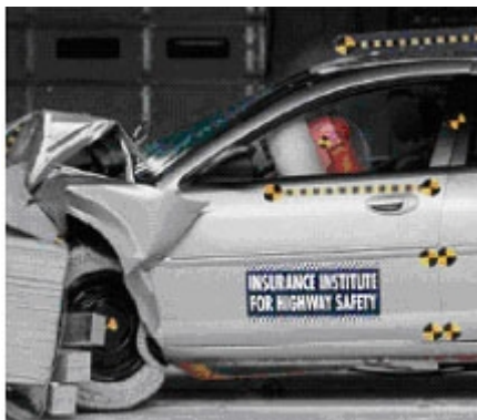
Ejemplo de deformación programada en el sector frontal de un vehículo
