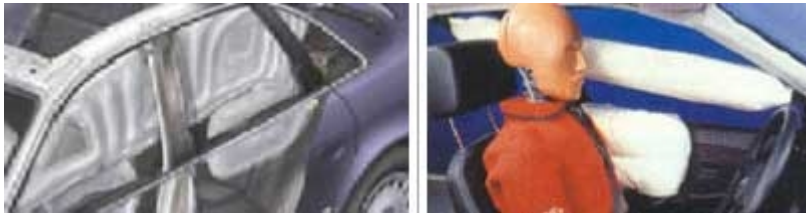
Tipos de airbag para la cabeza: de cortina (izquierda) y tubular (derecha)
