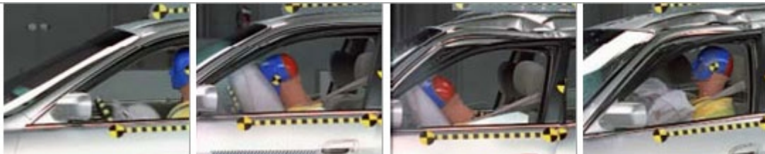
Secuencia de funcionamiento de un airbag frontal
